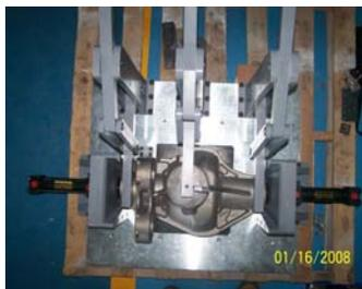
pieza a inspeccionar, contabiliza las piezas buenas y malas y genera estadísticas, con un tiempo de ciclo de 1 pza/30seg, además se incorporó al sistema ethernet de la empresa, el que no se
