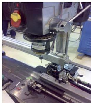
El proyecto consistió en desarrollar un dispositivo de posicionamiento automático acoplado a un taladro de pedestal para efectuar la operación de roscado de cuatro barrenos en una pieza de producción.
