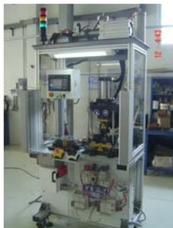
El proyecto consistió en desarrollar una estación semiautomática para la realización de tres marcas para posicionar la bobina dentro de la cubierta y el engargolado para encapsular la bobina del Cap Switch (bobina de arranque). La máquina asegura la repetibilidad y la calidad del
