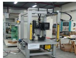
La máquina es semiautomática y se emplea para atornillado de yugos en barra de dirección para un nuevo modelo de vehículo, tiene capacidad de producción de 200 pzas/h. con esto la empresa abandona un proceso que se realizaba de forma manual, mejorando la calidad del ensamble y producto.
